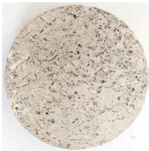
Рис. 1. Образцы фильтрующей керамики в форме дисков на основе диоксида циркония а) после утильного обжига, б) после окончательного обжига
