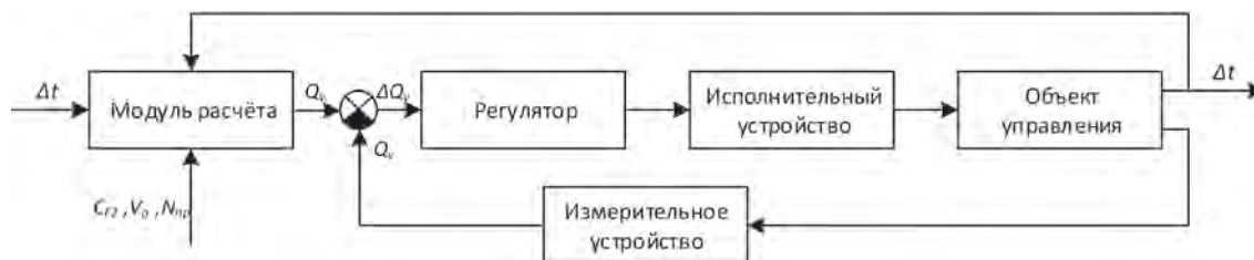
Рис. 1. Функциональная схема САУ расходом хладагента производства ГФУ
