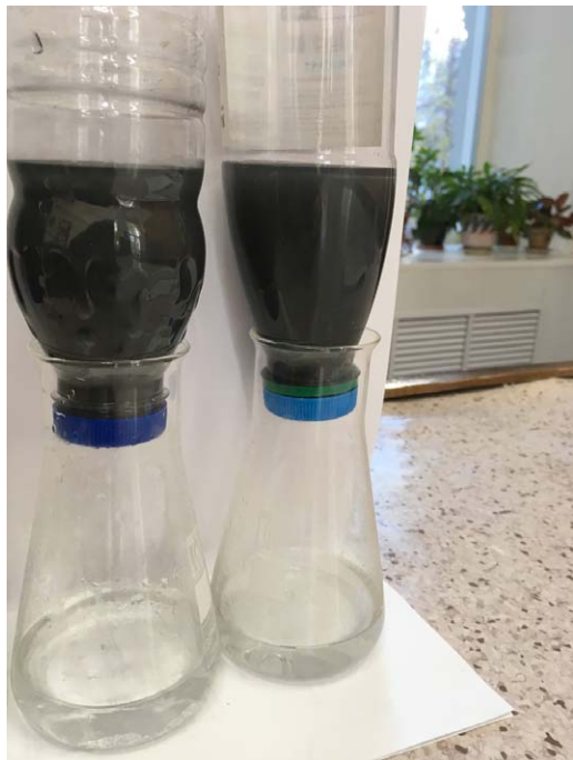
Рис. 2. Фильтрация водной суспензии наноразмерного порошка алюминия через керамический фильтр ( ZrO_2 ) с лабиринтной пористостью
