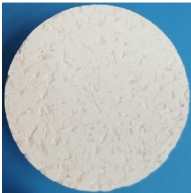
Рис. 1. Образцы фильтрующей керамики в форме дисков на основе диоксида циркония а) после утильного обжига, б) после окончательного обжига
