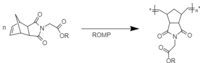
Рис. 1. Реакция ROMP полимеризации 5-норборнен-2,3-дикарбосимид-N-алкилацетатов: R - CH_3, C_2H_5, C_3H_7 изо- C_3H_7, C_4H_9 изо- C_4H_9
