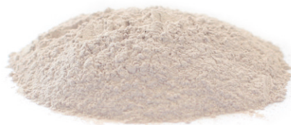
Рис. 2. Руда после измельчения на кольцевой мельнице
