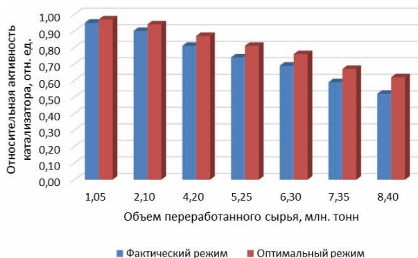
Рис. 2. Относительная активность катализатора при фактическом и оптимальном режиме
