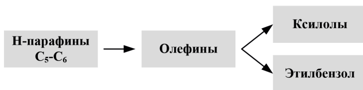
Рис. 1. Формализованная схема образования ксилолов и этилбензола
