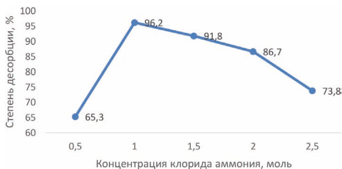
Рис. 2. Зависимость степени десорбции ионов цезия от концентрации хлорида аммония
