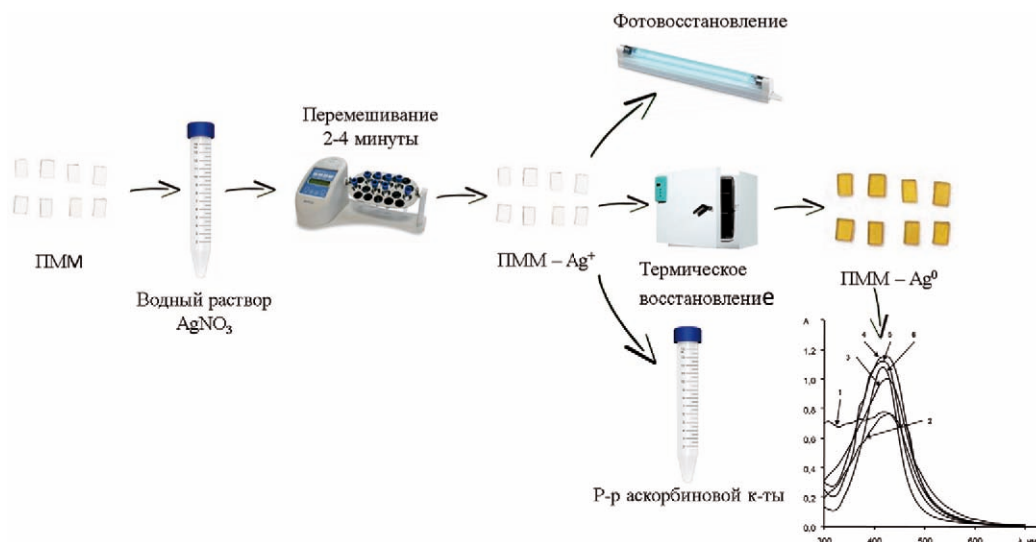
Рис. 1. Схема иммобилизации наночастиц серебра в ПММ
