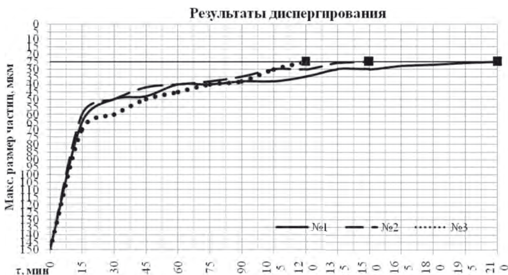
Рис. 1. Изменение максимального размера частиц в течение времени
