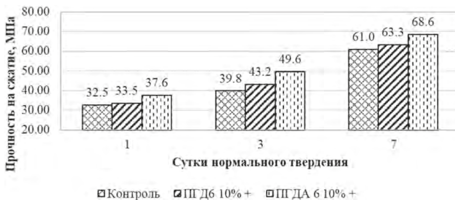
Рис. 2. Прочность образцов из цементной пасты
