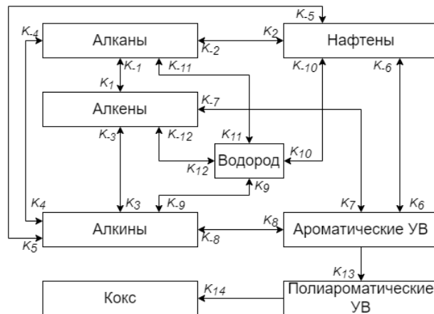
Рис. 1. Формализованная схема реакций процесса пиролиза
