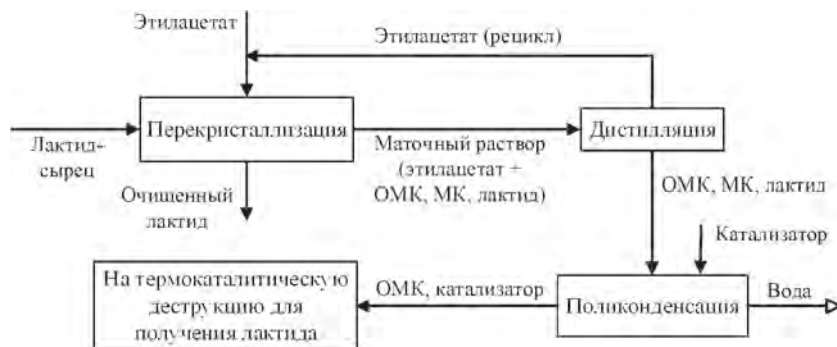
Рис. 1. Блок-схема утилизации маточного раствора со стадии перекристаллизации лактида
