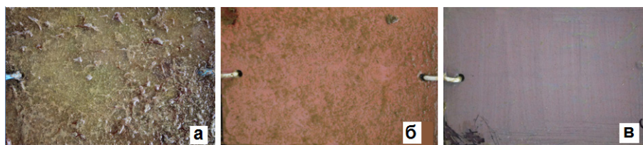
Рис. 2. Антиобрастающая активность образцов: контроль (а); «Биопласт» ( \text{CuO} ) (б); основа + \text{CuFe}_2\text{O}_4/\text{CuO}/\text{Cu}_2\text{O} (в)
