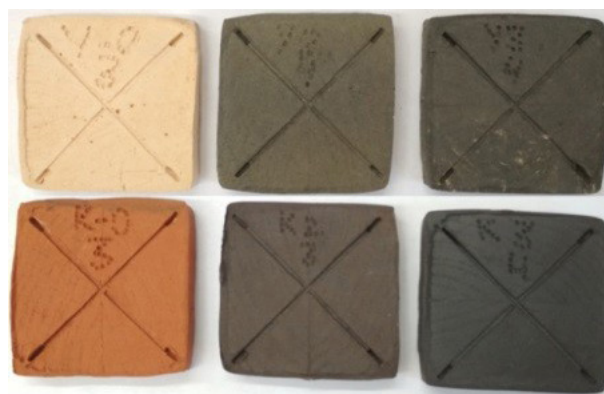
Рис. 1. Изменение окраски образцов из исследуемых глин с добавками оксидов-хромофоров, обожженных при 1 000 °С
