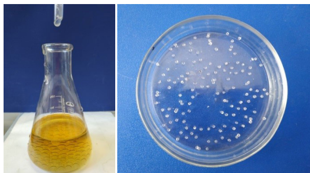
Рис. 1. (1а) Гранулирование золя с помощью капельного введения в масло; (1б) Готовый смешанный фотокатализатор на основе \text{SiO}_2/\text{TiO}_2
