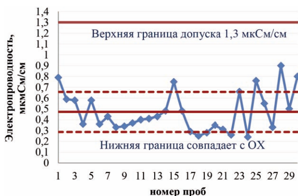
Рис. 1. Контрольная карта Шухарта для распределения средних значений измеренной электропроводности воды для инъекций
